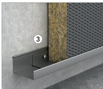
K podepření panelů jsou využívány obvodové profily J 40 mm (25/40/13 mm) a vzpěry. U obvodových profilů J tloušťky 1 mm není nutné použití vzpěr.
