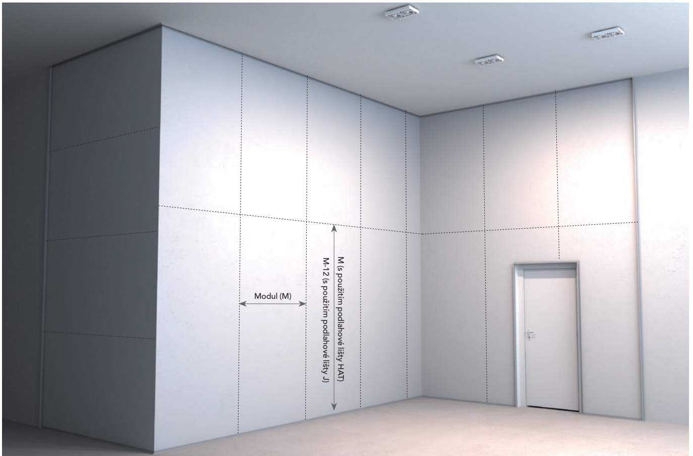
1.1 Označte všechny osy pro obvodové profily J nebo HAT a vnitřní HAT.
